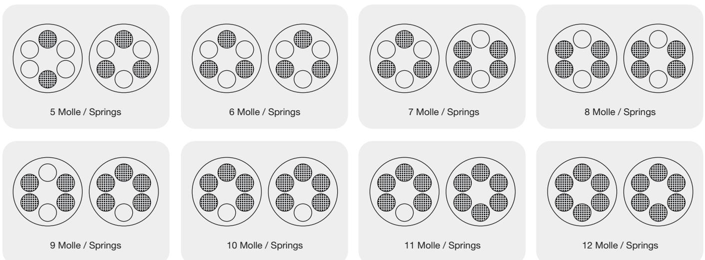
**Copie di azionamento attuatori singolo effetto (nm) /**
